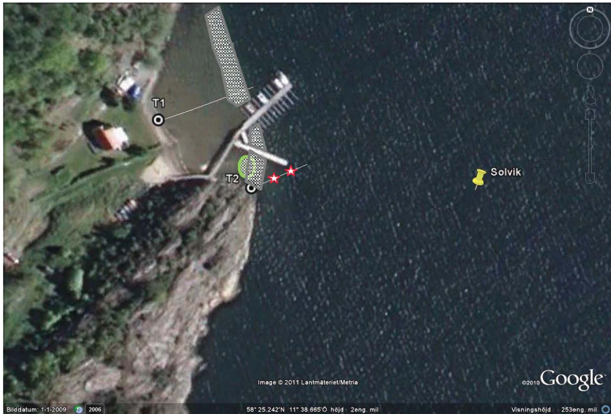
Figur 19. Resultat från bottenundersökning av Solvik. Ungefärliga baspositioner är indikerade med punkt omskriven av cirkel. Transekternas riktningar och ungefärlig längd (ej kompenserad för släntlutning) är indikerat med vit heldragen linje. Grönt raster avser bandgång. Röda stjärnor avser skrot eller bottenankare. Grått raster avser musselbank. Kartkälla Google Earth 2011-09-28. Överlagd grafik: Frog.
