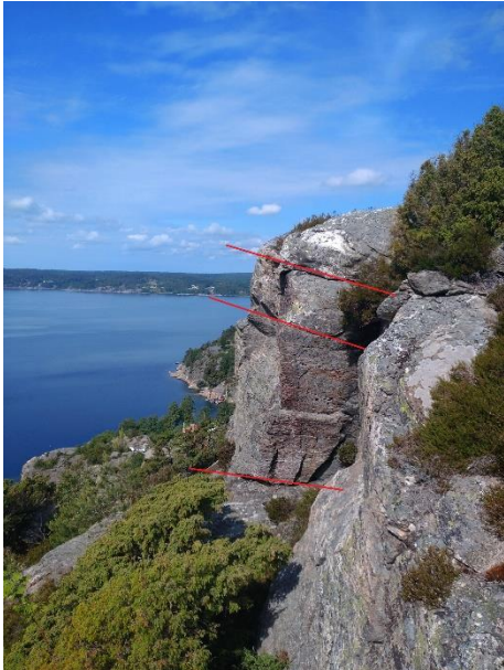
Figur 6. Horisontella sprickplan markerade med röda linjer.
