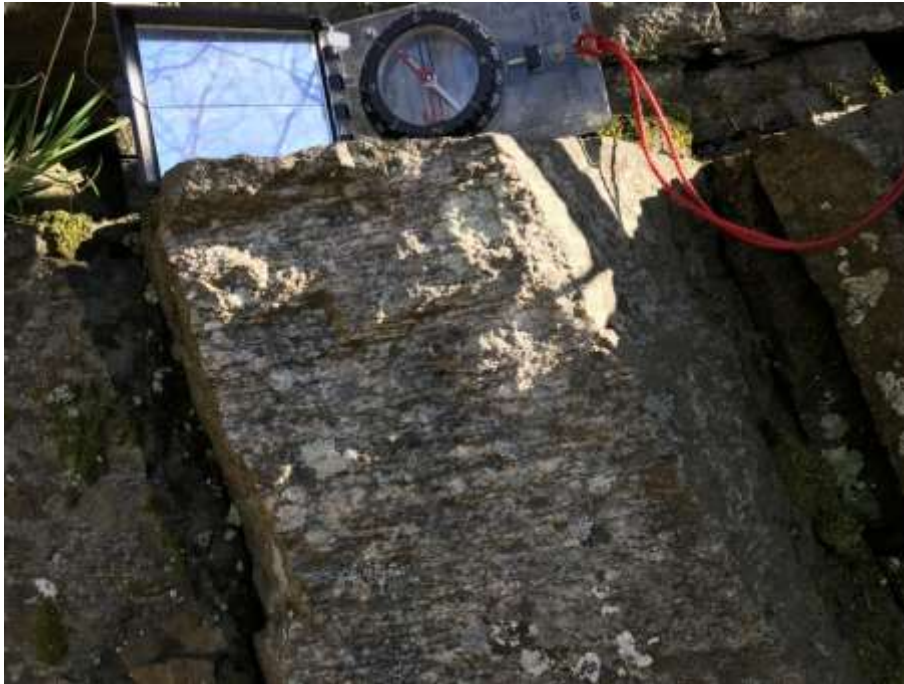
Figur 2. Förekommande bergart, sedimentådergnejs av Stora Le–Marstrandsformationen. Mätning i lägre delar i den västra slänten, med svag lutning.
