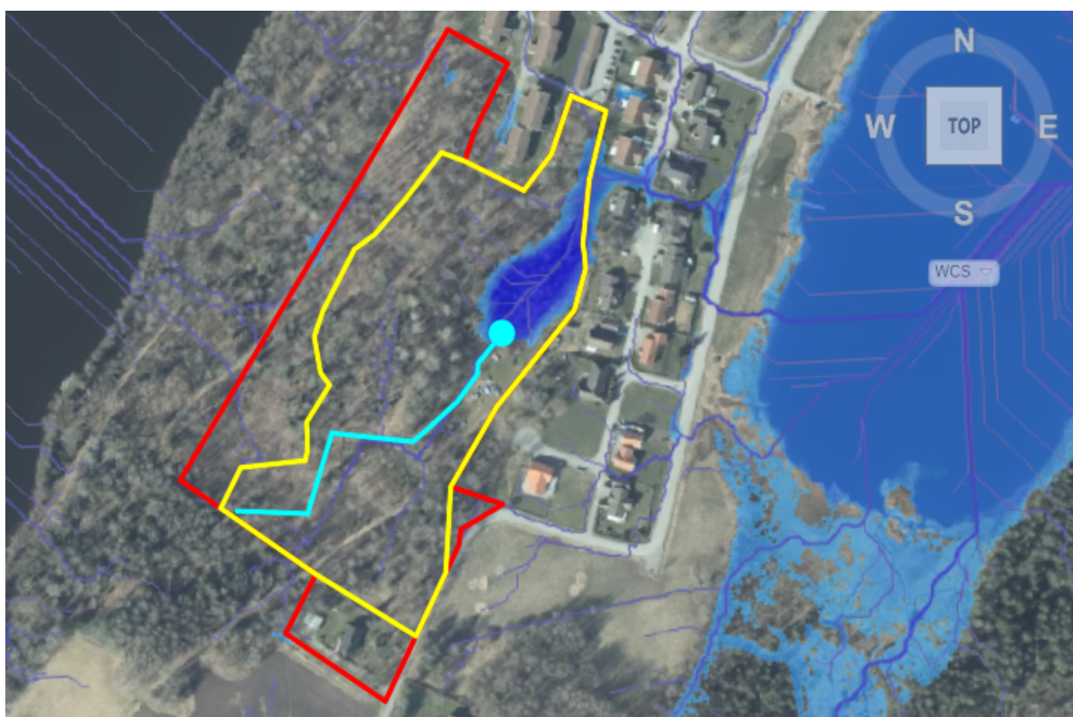
Figur 6. Område som bidrar med avrinning (i gult) till lågpunkten samt längsta rinnsträckan (i ljusblått), planområdet redovisas i rött.
