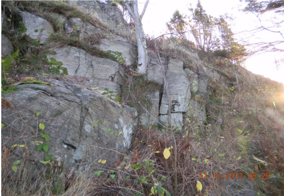
Figur 7. Lösa block i slänten, ca 0,5- 1 m breda, lössprucket på utåtlutande håll.
