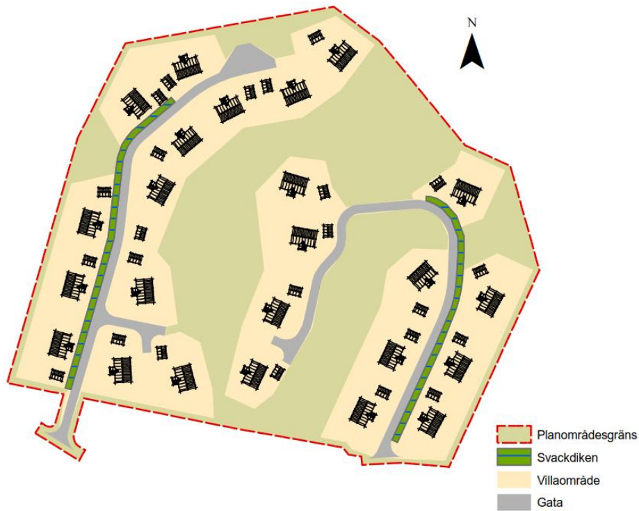
Figur 6. Principiell skiss av ytbehov för föreslagna svackdiken.
