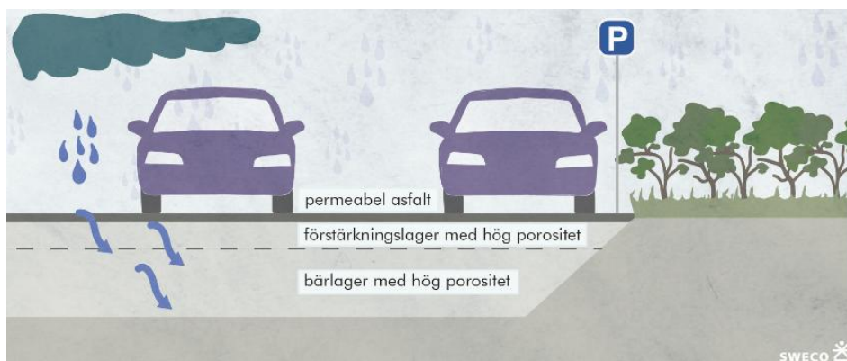
Figur 8. Principiell skiss av permeabelbeläggning och underliggande bärlager.
