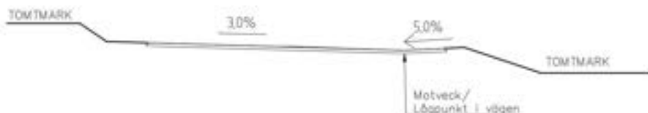
Figur 7. Principskiss på skevning av väg där skyfall kan avledas i vägens lågpunkt.
